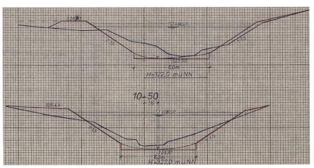
Bild 1: Querprofile vom Ausbau der Kupfer in Kupferzell (Baden-Württemberg). Blau: Ausgangszustand mit ausgeprägtem Niederwassergerinne; Rot: Ausbauzustand mit überbreitem Niedrig- und Mittelwasserprofil.
