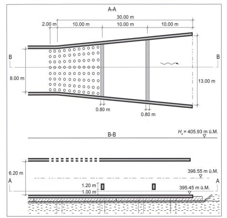
Bild 4: Mündungsbauwerk mit Aufweitung, perforierter Decke zur flächigen Entgasung und zwei Horizontalblenden für die Rekuperation von kinetischer Energie in Druck.
