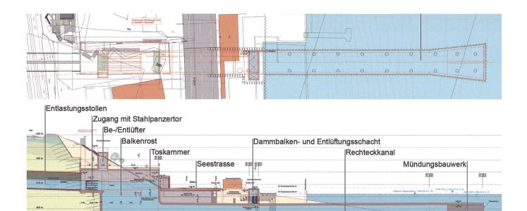
Bild 1: Übersicht und Längsschnitt der «Grundlösung» des Auslaufbauwerks, Stand Vorprojekt (Quelle: IG Sihl-Entlastungsstollen, c/o IUB Engineering AG, angepasst: VAW).
