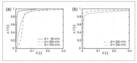
Bild 8: Luftkonzentration C über die Höhe des Rechteckkanals z/t an den Messstellen a)  $P_1$  in x=33,37 m und b)  $P_2$  in x=79,46 m für Q=90 m³/s, Q=200 m³/s und  $Q_d=330$  m³/s bei Seespiegel  $H_{S,m}=406,50$  m ü. M.
