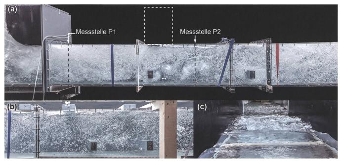
Bild 6: Strömungsstrukturen im ABW exemplarisch anhand des Dimensionierungsabflusses  $Q_d$  bei mittlerem Seespiegel  $H_{S,m}$ =406,50 mü. M. a) im Rechteckkanal: dispergierte Blasenströmung und Wirbelstrasse im Bereich der ersten beiden Horizontalblenden, b) im Mündungsbauwerk, c) flächige Entgasung über Entlüftungsöffnungen in der Decke des Mündungsbauwerks, die zum Teil fontänenartig an der Wasseroberfläche entweichen.
