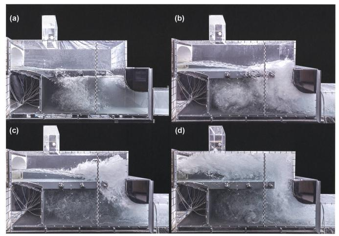
Bild 5: Strömungsstrukturen in der optimierten Toskammer für verschiedene Durchflüsse: a)  $Q=12\,\mathrm{m}^3/\mathrm{s}$ , b)  $Q=200\,\mathrm{m}^3/\mathrm{s}$ , c)  $Q_d=330\,\mathrm{m}^3/\mathrm{s}$  und d)  $Q_{\bar{U}LF}=400\,\mathrm{m}^3/\mathrm{s}$ . Das Strömungsbild ist a) vom Tauchstrahl und b) bis d) vom Oberflächenstrahl geprägt.
