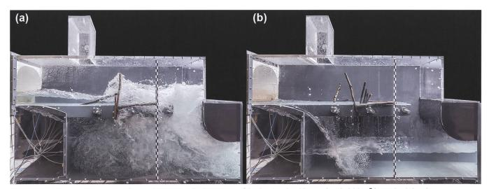
Bild 10: Verklausungen an den Querträgern des Balkenrosts a) im laufenden Versuch mit  $200\,\text{m}^3$ /s und minimalem Seespiegel  $H_{S,min}$ =405,50 m  $\ddot{\text{u}}$ . M. und b) nach Versuchsende.
