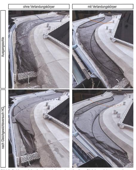
Bild 5: Sohle vor (oben) und nach (unten) stationären Gleichgewichtsversuchen bei  $HQ_2$ . Im Versuch ohne Verlandungskörper (links) landete deutlich mehr laufendes Geschiebe auf als im Versuch mit Verlandungskörpern (rechts).
