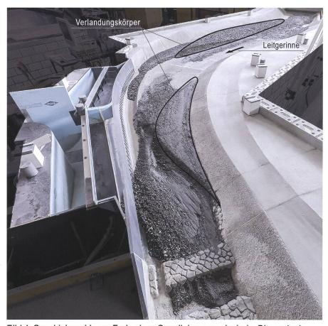
Bild 4: Geschiebesohle am Ende eines Ganglinienversuchs beim Dimensionierungsereignis  $HQ_{500}$ . Die Verlandungskörper oberstrom des Einlaufbauwerks und in der Innenkurve sind deutlich zu erkennen. Im Leitgerinne und in der Aussenkurve entlang des Einlaufbauwerks wurde das Sohlenmaterial bis auf den Molassefels erodiert.
