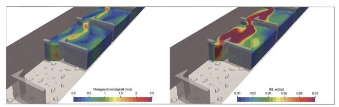
Bild 14: v (links) und TKE-Werte (rechts) an der Wasseroberfläche und durch den Schlitz für die Optimierungsvariante (VSP 3).
