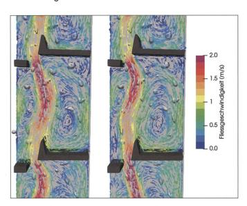
Bild 12: Strömungsvektoren an der WSP-Oberfläche im VSP 3, zu zwei unterschiedlichen Zeitpunkten für die Optimierungsvariante.
