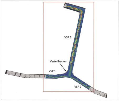
Bild 2: Modellperimeter der 3D-CFD-Modellierung (rot umrandet).
