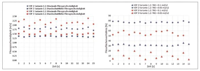
Bild 8: Links: QS-gemittelte v im Schlitz von VSP 2+3. Rechts: Prozentualer Anteil der QS-Fläche im Schlitz von VSP 2+3 mit TKE-Werten kleiner  $0.05 \,\mathrm{m}^2/\mathrm{s}^2$  resp.  $0.10 \,\mathrm{m}^2/\mathrm{s}^2$ .
