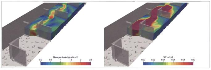
Bild 9: v (links) und TKE-Werte (rechts) an der Wasseroberfläche und durch den Schlitz für die Variante 1.2 (VSP 3).
