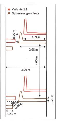
Bild 10: Beckenabmessungen VSP 3, Optimierungsvariante (braun), Variante 1.2 (rot).
