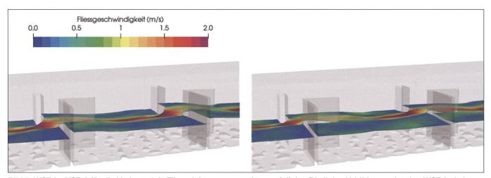
Bild 7: WSP im VSP 3 für die Variante 1.2, Fliessrichtung von rechts nach links. Die linke Abbildung zeigt den WSP bei einem SST-SM, die rechte bei einem HKS.
