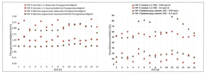
Bild 13: Links: QS-gemittelte v in einen Schlitz von VSP 3. Rechts: prozentualer Anteil der QS-Fläche im Schlitz von VSP 3 mit TKE-Werten kleiner  $0,05\,\text{m}^2/\text{s}^2$  resp.  $0,10\,\text{m}^2/\text{s}^2$ .
