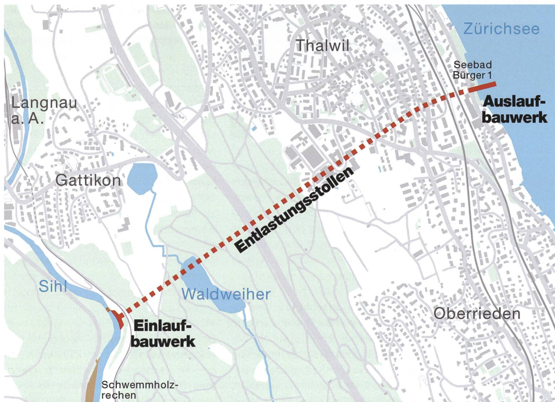
Bild 3: Der geplante Einlauf des Entlastungstollens befindet sich an der Sihl oberhalb von Langnau a. A., direkt unterhalb des neuen Schwemmholtzrechens. Im Bereich des Seebads Bürger 1 in Thalwil soll er in den Zürichsee münden.
