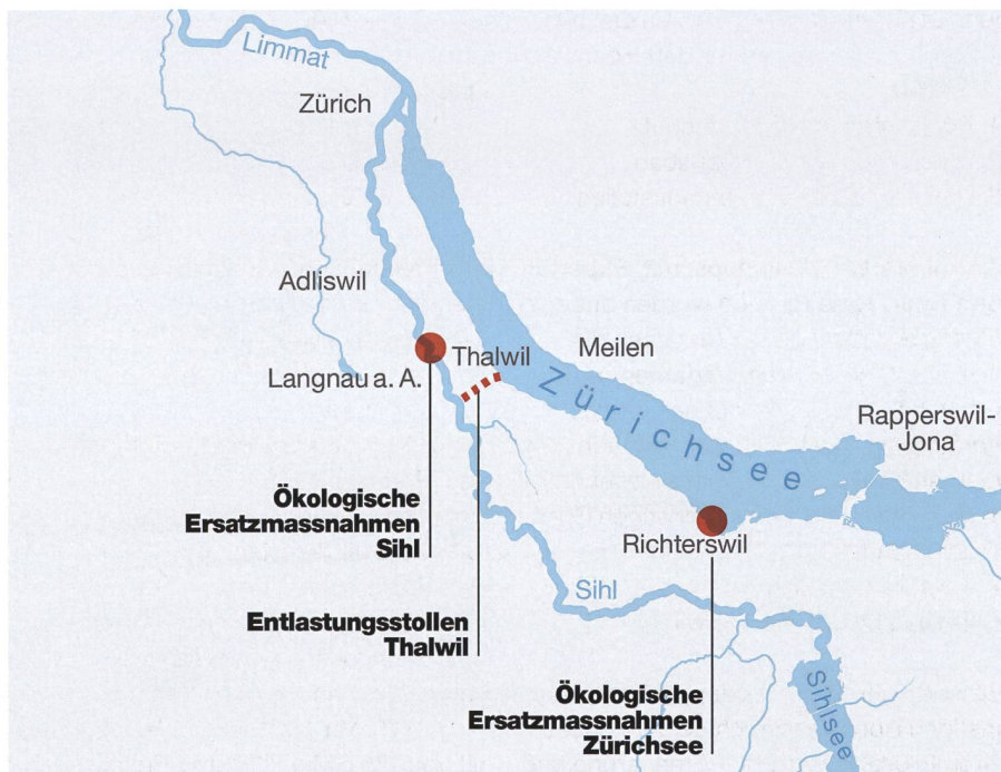
Bild 2: Zum Schutz des unteren Sihltals und der Stadt Zürich sollen mit dem Entlastungstollen Hochwasserspitzen der Sihl in den Zürichsee umgeleitet werden. Die gesetzlich vorgeschriebenen ökologischen Ersatzmassnahmen sind im Sihltal und am Zürichsee in Richterswil vorgesehen.
