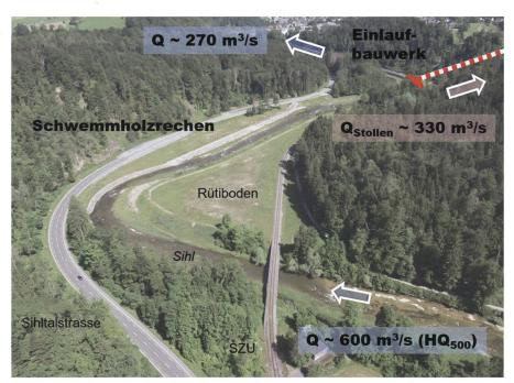
Bild 5: Aufteilung des Sihl-Abflusses (Q) im Bemessungsfall (HQ<sub>500</sub>).
