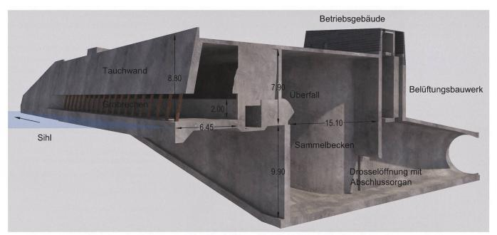
Bild 6: Schnitt durch das 3D-Modell des Einlaufbauwerks.
