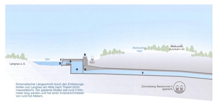
Bild 4: Schematischer Längsschnitt durch den Entlastungsstollen von Langnau a.A. nach Thalwil (nicht massstäblich).
