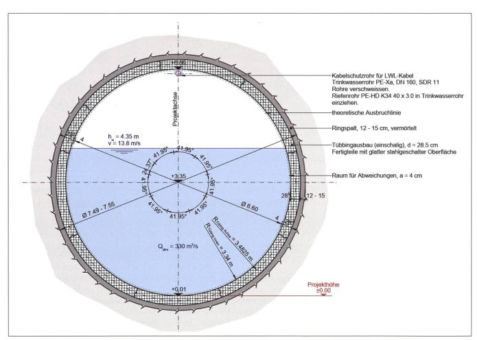
Bild 9: Normalprofil des Entlastungsstollens mit Tübbingausbau.
