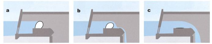
Bild 7: Betrieb des Einlaufbauwerks bei Sihl-Abfluss Q<250 m³/s (a), 250 m³/s <Q 350 m³/s (b) und Q>350 m³/s (c).
