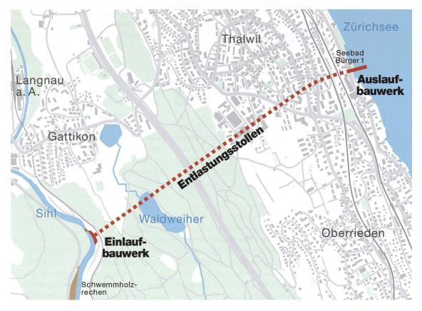
Bild 3: Der geplante Einlauf des Entlastungsstollens befindet sich an der Sihl oberhalb von Langnau a.A., direkt unterhalb des neuen Schwemmholzrechens Im Bereich des Seebads Bürger 1 in Thalwil soll er in den Zürichsee münden.
