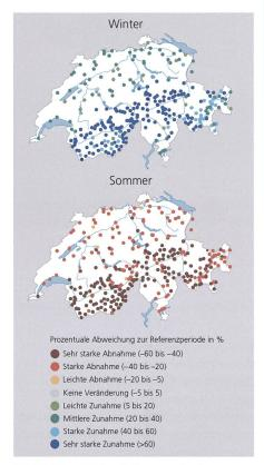
Bild 1: Erwartete Abflussveränderungen: Dargestellt sind die voraussichtlichen Veränderungen der saisonalen Abflüsse für verschiedene Einzugsgebiete bis Ende des Jahrhunderts (2070–2099) im Vergleich zur Referenzperiode (1981–2010), unter der Annahme, dass kein Klimaschutz erfolgt. Hydro-CH2018.
