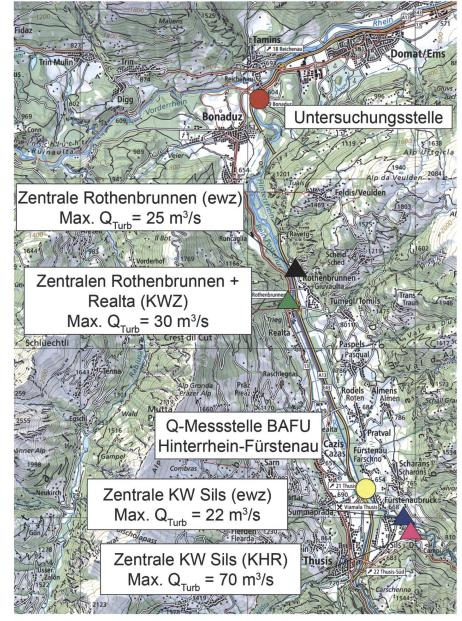
Bild 1: Systemüberblick mit den schwallerzeugenden Zentralen im Hinterrhein (farbige Dreiecke) sowie der Abflussmessstation Nr. 2387 Hinterrhein-Fürstenau (gelber Punkt) und der Untersuchungsstelle für die Strandungsversuche bei Bonaduz Isla (roter Punkt). KHR=Kraftwerke Hinterrhein, KWZ=Kraftwerke Zervreila, ewz=Elektrizitätswerke der Stadt Zürich. © Karte: swisstopo.
