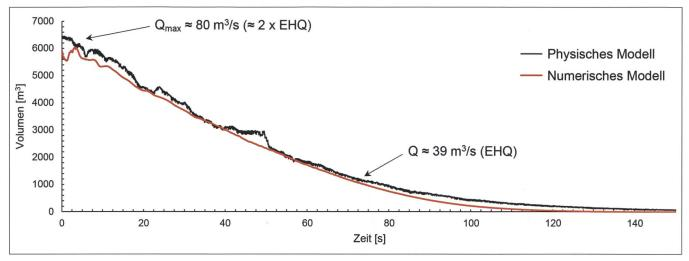
Bild 8: Abnahme des Tankvolumens - Vergleich numerisches und physisches Modell (EHQ).
