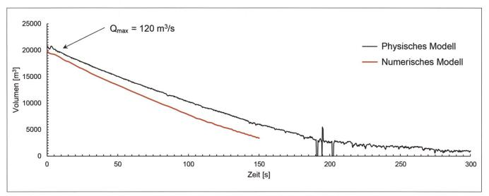
Bild 10: Abnahme des Tankvolumens - Vergleich numerisches und physisches Modell (Murgang).
