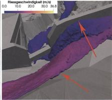
Bild 7: Blick auf die Murgangsperre bei der Simulation eines extremen Hochwassers (EHQ).
