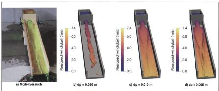
Bild 3: Einfluss des initialen Partikelabstandes d<sub>p</sub> auf das Simulationsergebnis und Vergleich mit dem Modellversuch.
