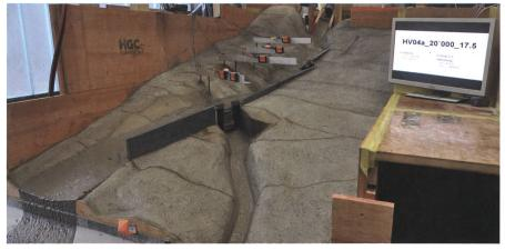
Bild 1: Murgangversuch am Labormodell.
