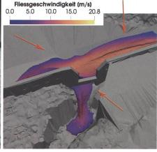
Bild 9: Blick auf die Murgangsperre bei der Simulation eines Murganges.
