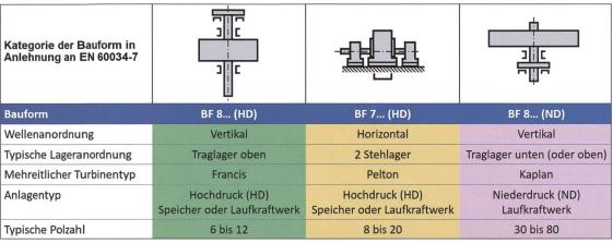
Bild 1: In der vorliegenden Studie verwendete Kategorien der Bauformen von Hydrogeneratoren.
