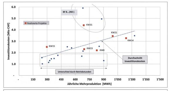
Bild 9: Investitionskosten der Generatorkomponenten in Funktion der jährlichen Mehrproduktion.
