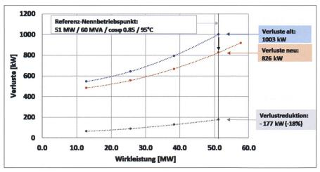
Bild 4: Gemessene Generatorverluste des Generators von Tabelle 1 vor und nach Erneuerung in Funktion der Wirkleistung bei einem  $\cos \varphi = 0.85$ .
