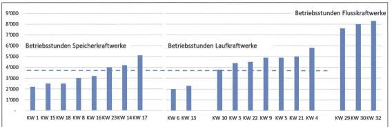
Bild 8: Durchschnittliche jährliche Betriebsstunden der Maschinengruppen: Mittelwert ohne Flusskraftwerke = 3800 Stunden (gestrichelte Linie).
