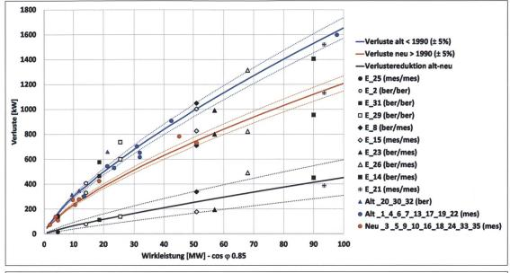
Bild 5: Verluste und Verlustreduktionspotenzial von Generatoren der Altersklassen vor und nach 1990.
