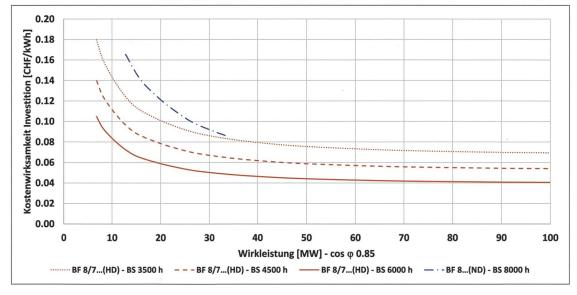
Bild 11: Kostenwirksamkeit der Investition bei einer Nutzungsdauer von 40 Jahren in Funktion der Leistung für verschiedene Bauformen und unterschiedliche Betriebsstunden.
