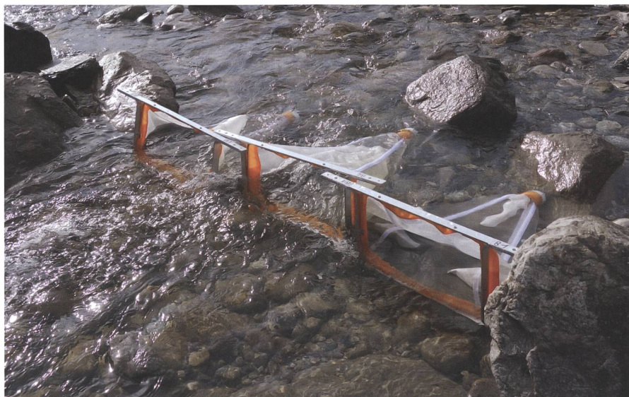
Bild 10: Mit solchen Netzen erfassen Eawag-Forscher die Zahl der weggeschwemmten Insektenlarven. Foto: Claire Aksamit, Eawag.
