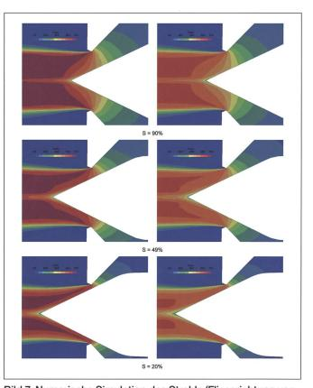
Bild 7: Numerische Simulation des Strahls (Fliessrichtung von rechts nach links) am Ausgang des Injektors der Peltonturbine für verschiedene Nadelöffnungen mit einer Fallhöhe von 287 m (links) bzw. 215 m (rechts). Der Einfluss der Fallhöhe auf die Qualität des Strahls ist minimal, doch die Geschwindigkeit nimmt ab. Grafik: J. Decaix, HES-SO Valais-Wallis.
