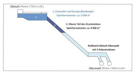
Bild 2: Diese (nicht massstabsgetreue) Darstellung zeigt die Bereiche, die als Speicher genutzt werden können: das Entsanderbecken und das Druckaufbaubecken sowie der obere Teil des Druckstollens. Grafik: SmallFLEX, bearbeitet C. Münch/HES-SO Valais-Wallis.
