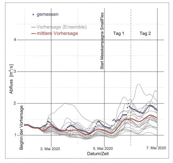
Bild 8: Vorhersage vom 2. Mai 2020 für die Wassermenge der Rhone während der SmallFLEX-Messkampagne (gemessen in m<sup>3</sup>/s). Die grauen Linien sind einzelne Vorhersagen des Abflusses mit unterschiedlichen Annahmen, die rote Linie zeigt die mittlere Fünftages-Vorhersage, die blaue Linie die tatsächlichen Werte. Grafik: Konrad Bogner, WSL.
