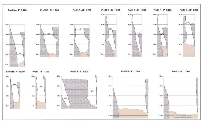
Bild 3: Vermessungsdaten aus Laserscan August 2017 mit ausgewählten Querprofilen.
