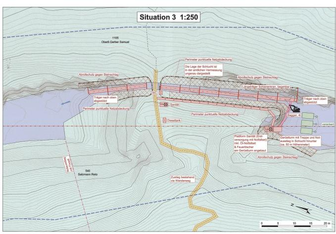
Bild 10: Situation des zentralen Teils der Baustelle Räbloch mit den wichtigsten Baustellenelementen. Quelle: Geotest AG, 2018.
