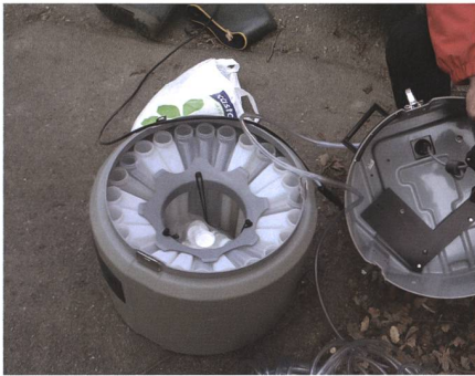
Bild 1c: Automatischer Probennehmer. Foto: A. Grasso.
