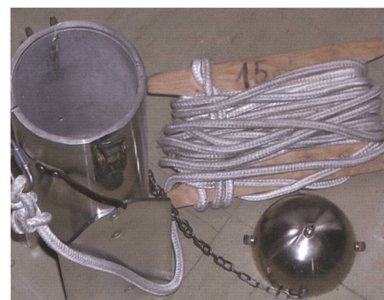
Bild 1a: Probenahme Schwebstoffsammler am Seil. Foto: A. Grasso.
