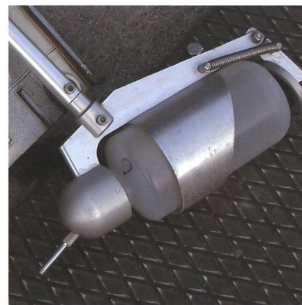
Bild 1b: Schwebstoffsammler an der Stange. Foto: A. Grasso.
