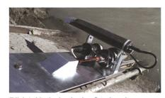
Bild 4: Hydrologische Station Aare-Brienzwiler; Messanlage mit zwei optischen Sonden und einer akustischen Sonde. Foto: D. Lussi, METAS.
