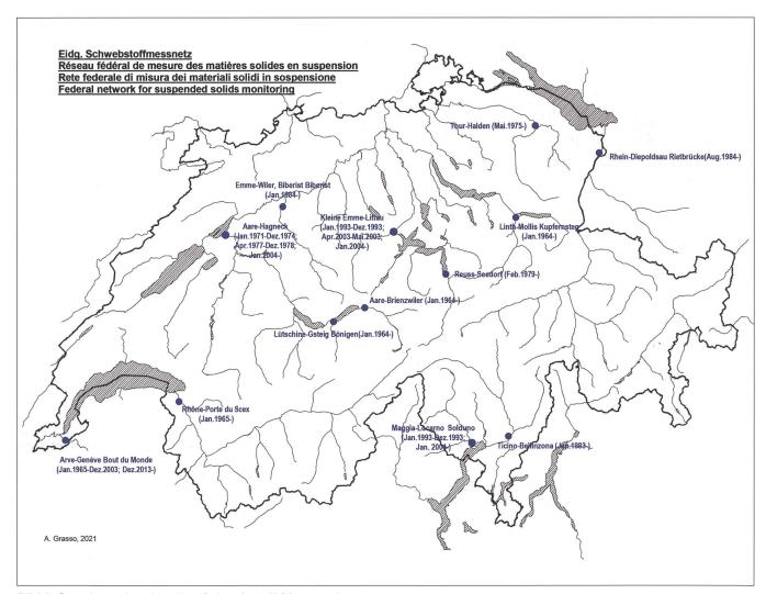
Bild 2: Standorte der aktuellen Schwebstoff-Messstationen.
