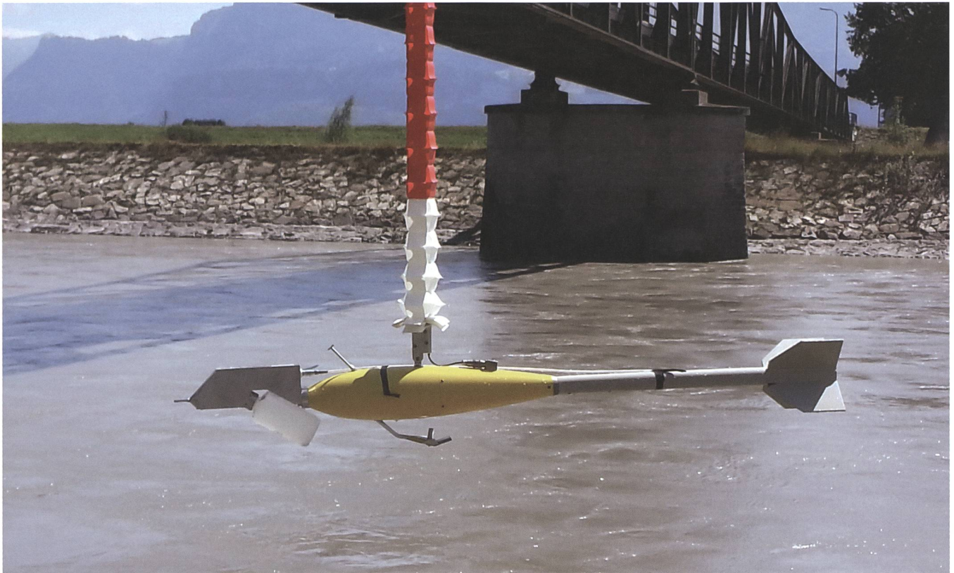
Bild 1: Vorrichtung zur Entnahme von Schwebstoffproben.
