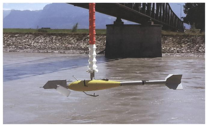
Bild 1: Vorrichtung zur Entnahme von Schwebstoffproben.
