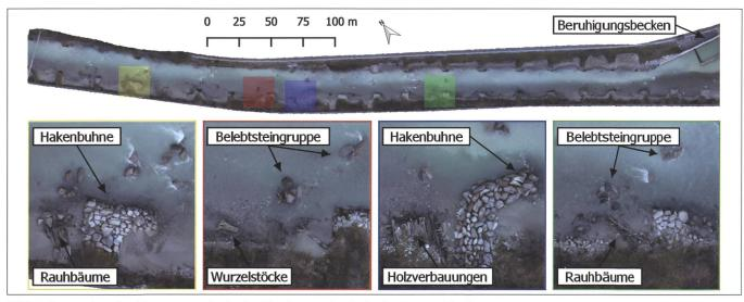
Bild 1: Illustration der Musterstrecke in der Hasliaare oberhalb der Aareschlucht.
