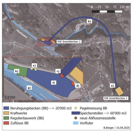
Bild 2: Schematische Darstellung von Speicherstollen, Beruhigungsbecken und Hasliaare. Bemerkung: Der Abflusspegel Aareschlucht befindet sich ausserhalb der Skizze. Die Buchstaben (a) bis (h) sind im Fliesstext von Kap. 2 erklärt.
