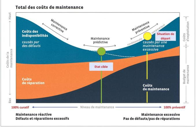
Figure 6: Recherche d'un optimum en fonction du degré de préventif de la stratégie de maintenance (Rouge et al., 2019).
