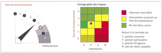
Figure 5: État de fonctionnement et principes de maintenance basée sur les risques (exemple).
