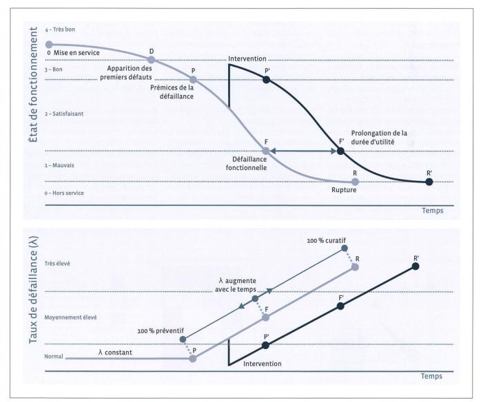
Figure 4: Définition des états de fonctionnement d'un actif.
