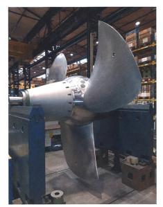
Bild 14: Laufrad HKW mit drei Laufradschaufeln (Foto: Groupe E).
