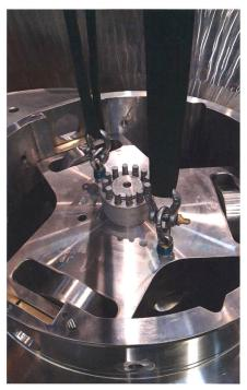
Bild 13: Verstellmechanismus des Kaplan-Laufrades (Foto: Groupe E).
