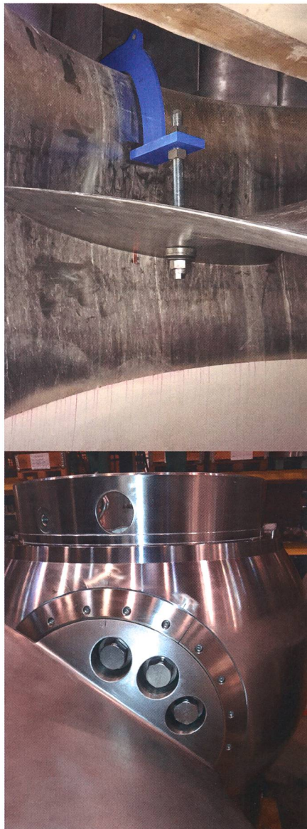
Bild 11: Reduzierter Spalt bei vollkugeligem Laufraddesign (Foto: Groupe E).
