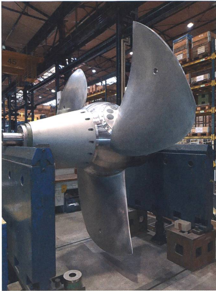
Bild 14: Lauffrad HKW mit drei Laufschaufeln (Foto: Groupe E).
