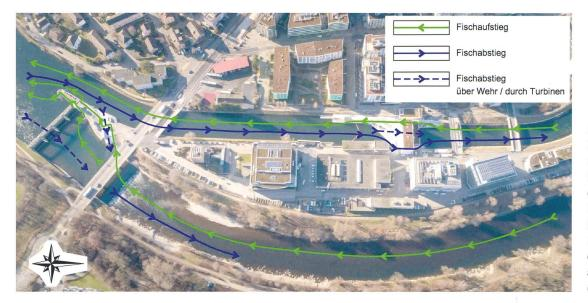
Bild 2: Mögliche Fischwanderrouten im Anlagenbereich des Kraftwerks Dietikon (Luftbild noch aus der Bauphase ohne die Schwellenabsenkung) (Foto: EKZ).
