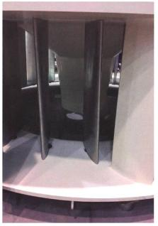
Bild 12: Ideale Ausrichtung der Stütz- und Leitschaufeln der Turbine (Foto: Groupe E).
