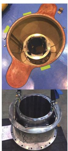
Bild 15: Wassergeschmiertes Turbinenlager (Foto: Groupe E).
