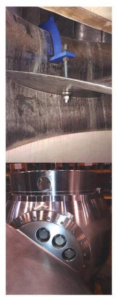
Bild 11: Reduzierter Spalt bei vollkugeligem Laufraddesign (Foto: Groupe E).
