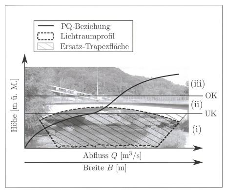
Bild 3: Schematische PQ-Beziehung bei Brücken: (i) Freispiegelabfluss bis zur Brückenunterkante (UK), (ii) Abfluss unter einer Schütz bis zur Brücken-/ Geländeroberkante (OK) und (iii) ein zusätzlicher Wehrabfluss für Wasserpegel > OK. Die Ersatz-Trapezfläche (schraffierte Fläche) ist flächenäquivalent zum Lichtraumprofil (gestrichelte Linie).
