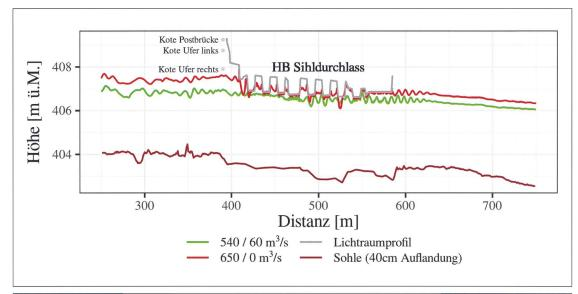
Bild 7: Längsprofil 3D-Modellierung für die beiden Überlastfälle (540/60 m³/s und 650/0 m³/s) entlang der Flussachse durch den mittleren Durchlass.
