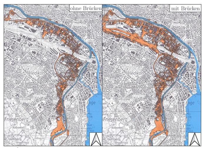
Bild 10: Überflutungsflächen (orange) auf dem Schwemmkegel der Sihl bei einem HQ300 (540 m³/s, Nettoprinzip) ohne Berücksichtigung der Brücken (links) und mit Berücksichtigung der Brücken (rechts).
