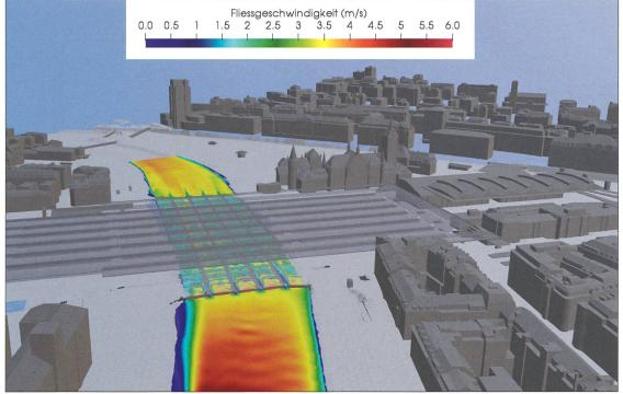
Bild 8: Fliessgeschwindigkeiten (an der Wasseroberfläche) beim Überlastfall (650/0 m³/s) der 3D-CFD-Simulation beim Sihldurchlass mit 3D-Stadtmodell (Blick in Fliessrichtung).
