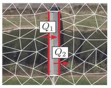
Bild 2: Schematische Darstellung des Berechnungsgitters (weisse Farbe) mit einer Brücke als innere Randbedingung: Am oberen Rand wird der Abfluss Q<sub>1</sub> (z. B. über eine PQ-Beziehung) vorgegeben und am unteren Rand wieder zugegeben (Q<sub>2</sub>).
