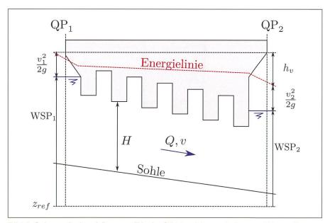
Bild 6: Schematisches Längsprofil beim Sihldurchlass mit den zwei Kontrollquerschnitten QP<sub>1</sub> (Einlauf) und QP<sub>2</sub> (Auslauf).
