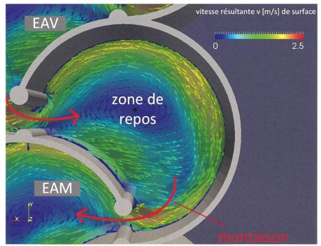
Figure 12: Cheminement des poissons (flèches rouges) à travers les fentes d'une passe à méandres de type *C* (simulation 3D avec OpenFOAM® méthode SGS, vitesse de surface, EAV=en aval, EAM=en amont; source TU Dresden/IWD).
