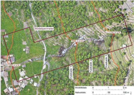
Bild 3: Modellperimeter und Längsprofil des physikalischen Modells. Der Perimeter umfasst die untersten drei Wasserfälle sowie den oberen Teil der Wildbachschale. Im Längsprofil markieren die Punkte 1 bis 5 die Messquerschnitte und das Symbol 🛘 den Murgangtank.
