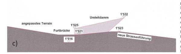
Bild 6: Variante Umleitung: a) vor und b) während eines 100-jährlichen Murgangereignisses und c) angepasste vertikale Strassenführung unterhalb des Umleitdamms (Blick entgegen der Fliessrichtung). Die Dammhöhen sind abhängig von der Strassenführung.
