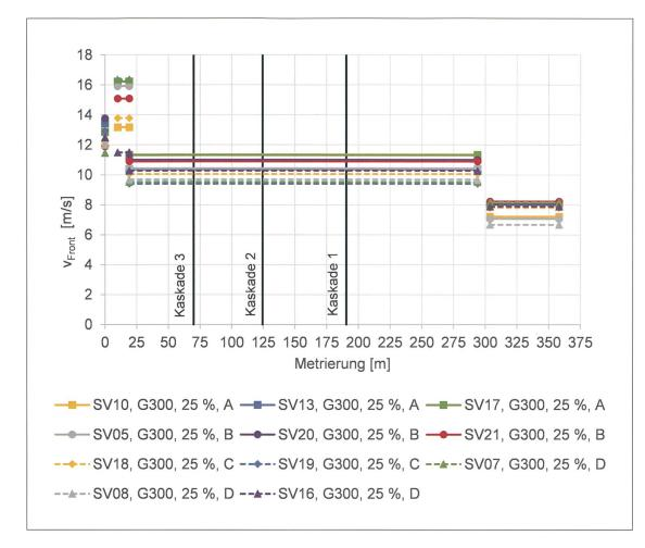
Bild 5: Mittlere Fliessgeschwindigkeit der Murgangfront (v<sub>Front</sub>) von einem Messquerschnitt zum nächsten für ein 300-jährliches Ereignis (G300) mit einem Wassergehalt von 25 % für vier verschiedene Murgangmischungen: A: < 0.4 m;
