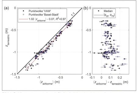
Bild 4: Sohllagen ⟨z<sub>airborne</sub>⟩ der mit Gl. 2 refraktionskorrigierten Punktwolke in Relation zu Sohllagen z<sub>terrestric</sub> aus Daten der terrestrischer Vermessung.
