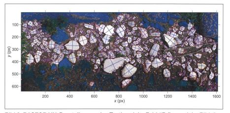
Bild 8: BASEGRAIN-Darstellungen des Testbereichs Feld #B (Lage siehe Bild 1). Foto mit Skalierung 1/640 px m<sup>-1</sup>, d.h. mit Abmessung 1,0 x 2,5 m<sup>2</sup>. Darstellung von detektierten und vermessenen Kiesflächen, wobei die blauen Achsen jeweils die Haupt- und Mittelachse einer quasi-flächengleichen Ellipse wiedergeben.
