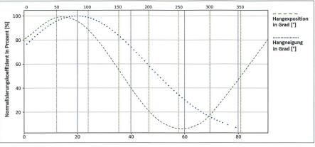
Bild 2: Empirisch abgeleiteter Zusammenhang zwischen Schneehöhen und der Hangneigung/Hangexposition. Der darauf basierende Normalisierungskæffizient (Y-Achse) fungiert als Indikator für die Gewichtung der absoluten Schneehöhen.
