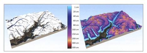
Bild 3: Die Region Aletsch in einer Echtfarben-Darstellung, aufgenommen durch den Satelliten Sentinel-2 (links), und die daraus abgeleitete Karte der Schneebedeckung und Schneehöhenverteilung (rechts). Aufnahmezeitpunkt: 3.12.2019.
