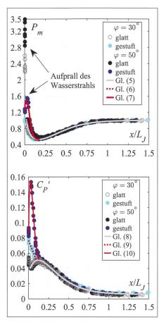
Bild 7: Druckverteilung entlang der Tosbeckensohle als Funktion der normierten Koordinate  $x/L_J$ , (a) mittlerer Wasserdruck  $P_m$  und Gleichungen (5), (6) und (7), (b) Druckschwankungen  $C_P$ ' und Gleichungen (8), (9) und (10).
