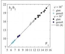
Bild 6: Vergleich der gemessenen konjugierten Abflusstiefen  $h_2/h_1$  mit GI. (4).
