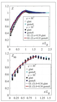
Bild 5: Dimensionslose Abflusstiefen entlang des Tosbeckens versus dimensionslose Koordinate  $x/L_R$ , (a) mittlere Abflusstiefe Z mit GI. (2) und (b) charakteristische Abflusstiefe  $Z_{90}$  mit GI. (3).
