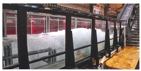
Bild 2: Physikalisches Modell im Wasserbaulabor LCH, EPFL.
