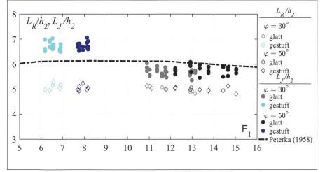
Bild 4: Dimensionslose Walzen- $L_{\rm R}/h_2$  und Wechselsprunglänge  $L_{\rm J}/h_2$  in Funktion der Zufluss-Froude-Zahl F<sub>1</sub>, verglichen mit der Wechselsprunglänge nach Peterka (1958) für glatte Schussrinnen.
