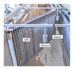
Bild 2: Der insgesamt 30 Meter lange und 1.2 Meter tiefe Kanal der Versuchsanstalt für Wasserbau, Hydrologie und Glaziologie ist auf dem Bild mit einem Vertikalrechen mit gebogenen Stäben (CBR) ausgerüstet. Der Pfeil zeigt die Fliessrichtung, wenn der Versuchskanal mit Wasser gefüllt ist (Foto: VAW).
