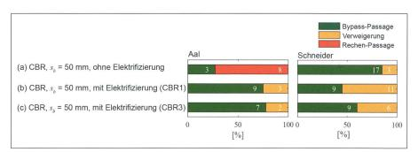
Grafik 4: Die Grafik zeigt, wie Aale und Schneider auf Vertikalrechen mit gebogenen Stäben (CBR) reagiert haben-bei a) ohne und bei b) und c) mit Elektrifizierung (für zwei unterschiedliche Pulsparameter). Die Zahlen in der Grafik beziehen sich auf die Menge der untersuchten Fische (Grafik: Schlussbericht EthoMoSt).
