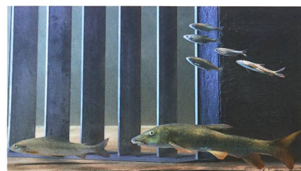
Bild 10: Barben (unten) und Schneider (oben rechts) schwimmen an einem Fischleitrechen im Labor (Foto: VAW).
