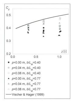
Figure 9: Coefficients  $C_d$  en fonction de  $\chi$  pour un prolongement de la tête du pilier.
