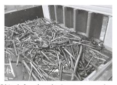
Figure 6: (a) Troncs créant le blocage, et (b) tapis formé par les troncs en amont du déversoir.
