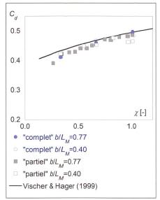
Figure 14: Coefficients du déversoir  $C_d$  en fonction de  $\chi$  pour les tests avec un râtelier
