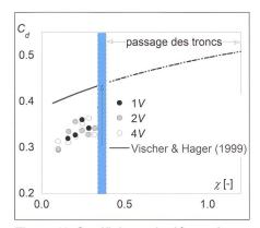
Figure 11: Coefficients du déversoir  $C_d$  en fonction de  $\chi$  pour un déversoir sans piliers.
