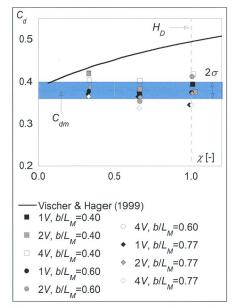
Figure 8: Ensemble des coefficients  $C_d$  pour les tests sans contre-mesures.
