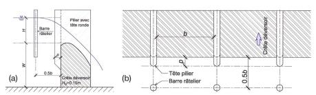
Figure 1: Schéma du déversoir et nomenclature, (a) coupe, et (b) vue en plan.
