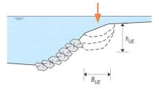
Figure 6: Erosion au sommet de la berge.
