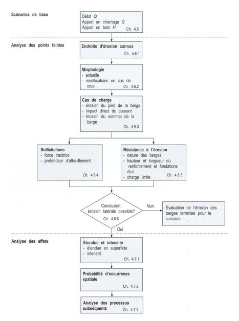
Figure 3: Procédure générale d'évaluation des dangers d'érosion des berges.
