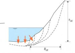
Figure 4: L'érosion du lit, l'affouillement ou l'érosion du pied déstabilisent la berge (à gauche, berge basse, à droite, berge élevée).
