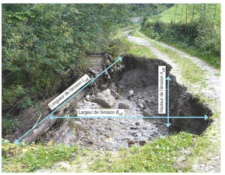
Figure 7: Mesures de l'ampleur de l'érosion. Photo: OFOR 2005
