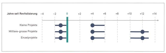
Abbildung 6: Zeitpunkt der Vorher- und Nachher-Erhebungen im Rahmen der Wirkungskontrolle STANDARD in Abhängigkeit der Projektgrösse.
