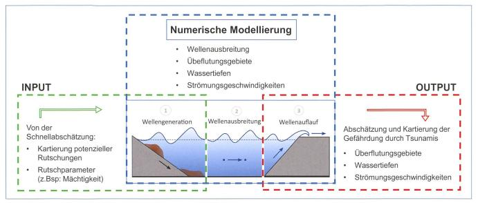
Abbildung 4: Ablauf der Abschätzung von potenziellen Gefährdungen durch Tsunamis mit dem numerischen Modell. Die schwarzen Pfeile zeigen die Bewegung der Rutschung, während die blauen Pfeile die Wellenausbreitung und den Wellenauflauf repräsentieren.
