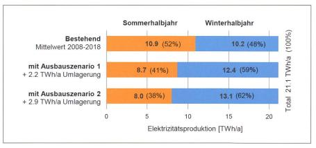
Bild 6: Verstärkte Umlagerung der Elektrizitätsproduktion aus Speicherwasserkraft auf das Winterhalbjahr mit den Stausee-Ausbauszenarien gemäss *Tabelle 4.*
