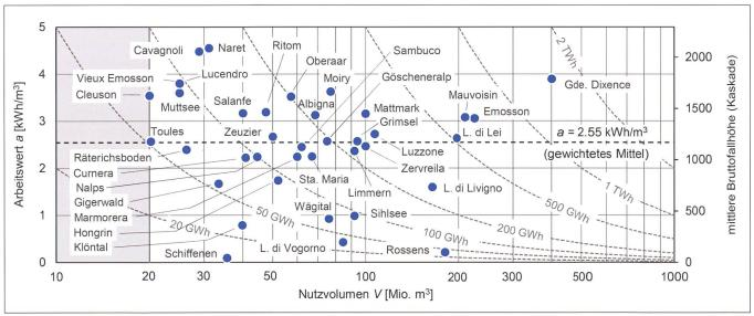
Bild 2: Nutzvolumen, Arbeitswerte und Energieinhalte der bestehenden grösseren Stauseen (>20 Mio. m³) in der Schweiz.
