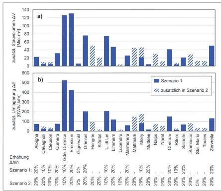
Bild 5: a) Zusätzliche Stauvolumen und b) zusätzlich in das Winterhalbjahr umlagerbare Elektrizitätsproduktion in den Szenarien 1 und 2 (26 Speicher mit bestehendem Nutzvolumen > 20 Mio. m³ in alphabetischer Reihenfolge).
