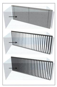
Bild 2. Beispielgeometrie eines Horizontalrechens (oben), Louvers (Mitte) sowie klassischen Bar Racks (unten) mit Schräganströmung. Die schwarzen Pfeile repräsentieren den Anströmvektor.
