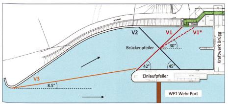
Bild 5. Potenzielle Anordnungen für Fischabstiegshilfen beim Kraftwerk Brügg. Die Varianten V1 und V1\* weisen vor der rechten Turbine die gleiche Linienführung auf. In Grün dargestellt ist die vorhandene Fischaufstiegsanlage in Form eines Vertikalschlitzpasses. Die schwarzen Pfeile zeigen die Fliessrichtung an.
