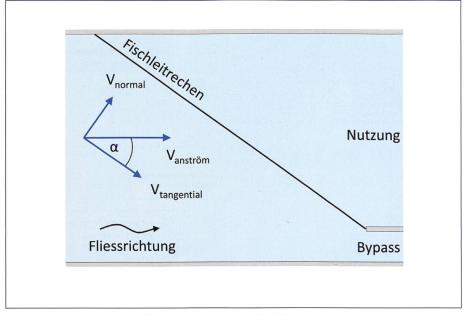
Bild 1. Anordnung eines Leitrechensystems mit Schräganströmung (charakterisiert durch den Anströmwinkel α) und dazugehörigen Geschwindigkeitsvektoren.
