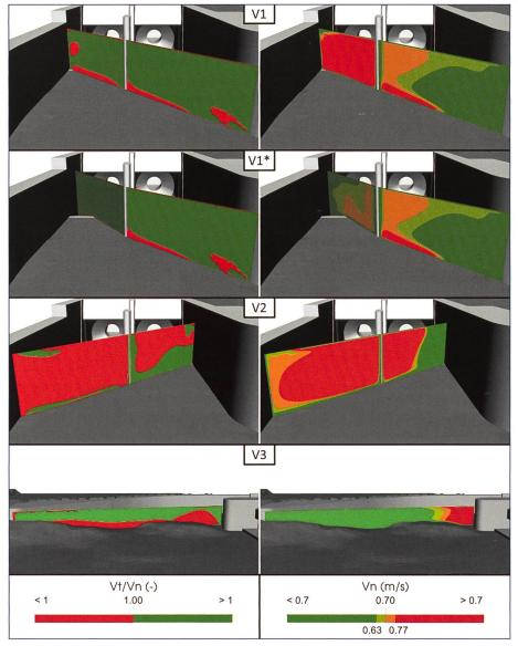
Bild 7. Links: Verhältnis der tangentialen ( $V_t$ ) zu den normalen Geschwindigkeiten ( $V_n$ ) für die vier berücksichtigten Varianten. Bei einem Quotienten grösser als 1 kann mit einer guten Leitwirkung gerechnet werden. Rechts: Bewertung der Normalgeschwindigkeiten für eine Fisch-Dauerschwimmgeschwindigkeit  $v_{opt}$  = 0.7 m/s. Zusätzlich sind die Isotachen bei ±10 % dieses Grenzwertes dargestellt.
