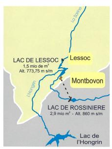
Figure 2. Schéma hydraulique de l'aménagement de la Haute-Sarine.
