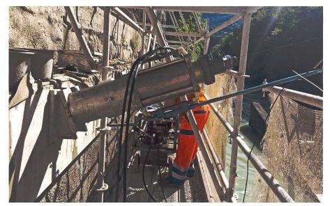
Figure 8. Presse pour l'essai d'arrachement.
