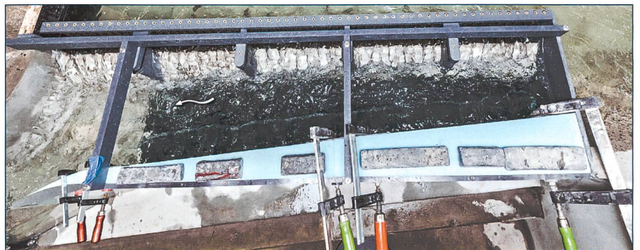
Bild 15. Strömungsbild in der Sammelrinne mit Rotationsströmung und Luftschlauch im Wirbelkern während des Spitzenabflusses des HQ_{300} .
