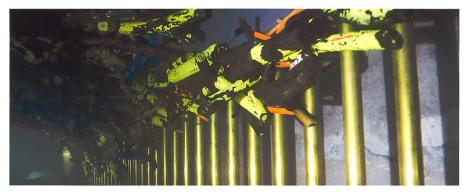
Bild 13. Im Vergleich zu Variante TW II (vgl. Bild 10) deutlich reduzierte Verklausungsanfälligkeit der Bestvariante «Rechen mit Blende». Blick gegen die Fliessrichtung.
