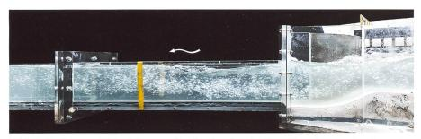
Bild 16. Strömungsbild mit Stosswellen im Bereich der Beschleunigungsstrecke und des Stolleneinlaufs sowie stirnseitiges Anschlagen am Stolleneinlauf bei HQ<sub>300</sub>.
