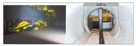
Bild 10. Links: Starke Verklausung des Einlaufbauwerks bei einem Versuch mit Variante TW II. Rechts: Übergang des Stollens in zwei rechteckige Düker, die jeweils mit einem Schütz ausgestattet sind. Im rechten Bereich des Stollens ist eine Leiter montiert (rot markiert), welche die Verklausungsgefahr zusätzlich erhöht.
