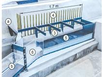
Bild 4. Links: Blockrampe (1) und Niederwasserrinne (2) im hydraulischen Modell. Blick gegen die Fliessrichtung. Rechts: Einlaufbauwerk auf Grundlage des Vorprojekts mit für Modellbetrieb überhöhtem Grobrechen (4).
