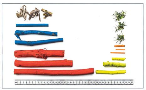
Bild 6. Unterschiedlich eingefärbte Klassen des Modellschwemmholzes: Stammholz (rot), grosses Astholz (blau), kleines Astholz (gelb), Feinanteile (orange, grün), Wurzelstöcke (naturbelassen).
