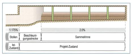
Bild 14. Längsschnitt der Sammelrinne und der Beschleunigungsstrecke. Fliessrichtung von rechts nach links.
