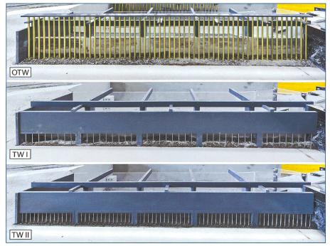
Bild 9. Ansichten Einlaufbauwerk. Oben: Variante «oTW» – Rechen ohne Tauchwand, lichter Stababstand (LSA) = 0.3 m, Stabdicke = 0.16 m. Mitte: Variante «TW I» – Rechen mit Tauchwand I, LSA = 0.5 m, Stabdicke = 0.06 m. Unten: Variante «TW II» – Rechen mit Tauchwand II, LSA = 0.3 m, Stabdicke = 0.06 m.
