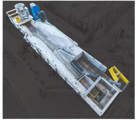
Bild 5. Hydraulisches Modell des Einlaufbauwerks Würzenbachstollen im Massstab 1:15. Fliessrichtung von links nach rechts.
