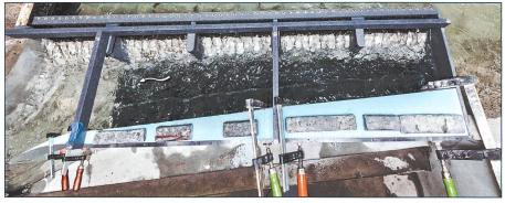
Bild 15. Strömungsbild in der Sammelrinne mit Rotationsströmung und Luftschlauch im Wirbelkern während des Spitzenabflusses des HQ<sub>300</sub>.
