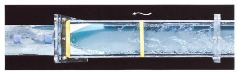
Bild 17. Sicht auf den Stollen im Bereich des Übergangs von Rechteck- auf Kreissegmentstollen bei  $HQ_{300}$ .
