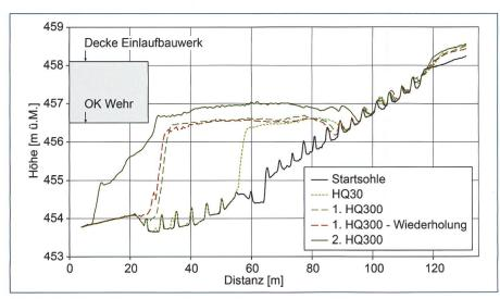
Bild 7. Längenprofile der kumulierten Auflandungskörper eines HQ<sub>30</sub>- mit zwei aufeinanderfolgenden HQ<sub>300</sub>-Versuchen sowie eines ersten HQ<sub>300</sub>-Wiederholungsversuchs in Relation zur Lage des Einlaufbauwerks (Schnittführung entlang Fliessachse, lokal im Talweg).
