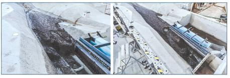
Bild 8. Links: Auflandungskörper und Lage der Verlandungsfront nach Ende eines ersten  $HQ_{300}$ -Versuchs. Rechts: Auflandungskörper nach Ende eines zweiten  $HQ_{300}$ -Versuchs mit massivem Geschiebeeintrag in den Stollen. Blick jeweils gegen die Fliessrichtung.
