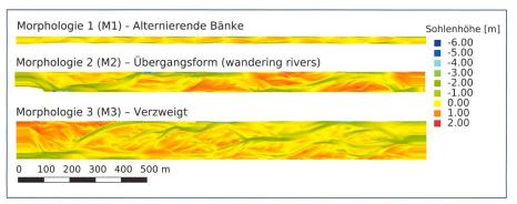
Bild 1. Verwendete Flussmorphologien, basierend auf Laborexperimenten.
