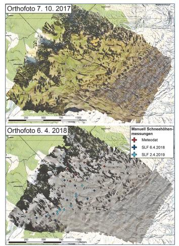
Bild 7. Drohnen-Orthofotos vom Sommer (oben) und Winter (unten) mit den Positionen der manuellen Schneehöhenmessungen. Hintergrundkarte pixmaps©2019 swisstopo (5704 000 000). Reproduziert mit der Bewilligung von swisstopo (JA100118).
