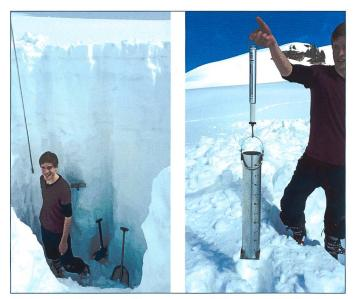
Bild 2, oben. Schneedichtemessung mit der sog. ETH-Sonde.
