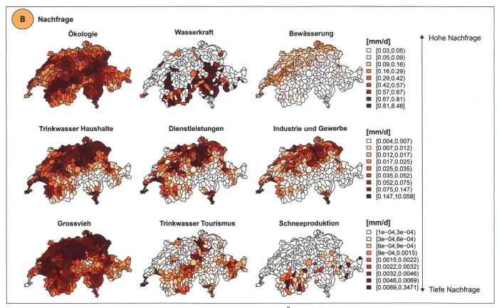
Bild 5. Räumliche Verteilung der Wassernachfrage pro Nutzungskategorie: Ökologie (Rest- und Mindestwassermenge), Wasser-kraft, Bewässerung, Trinkwasser Haushalte, Industrie & Gewerbe (Sektor zwei), Dienstleistungen (Sektor drei), Grossvieh, Trinkwasser Tourismus und Schneeproduktion. Die Wassernachfrage nimmt von oben nach unten ab. Jede Kartenreihe hat eine eigene Skala.
