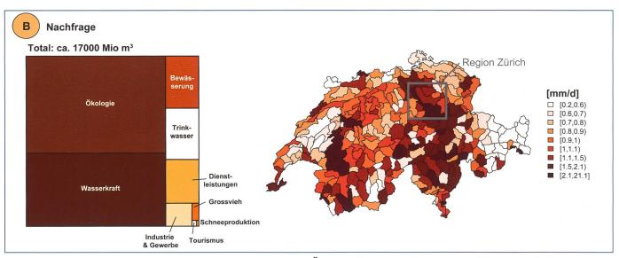
Bild 4. Gesamtwassernachfrage pro Nutzungskategorie und Jahr: Ökologie (Rest- und Mindestwasser), Wasserkraft, Bewässerung, Trinkwasser, Industrie & Gewerbe (Sektor zwei), Dienstleistungen (Sektor drei), Grossvieh, Trinkwasser Tourismus und Schneeproduktion (links) und die räumliche Verteilung der Gesamtnachfrage. Das graue Rechteck zeigt die Region Zürich mit einer vergleichsweise hohen Wassernachfrage.
