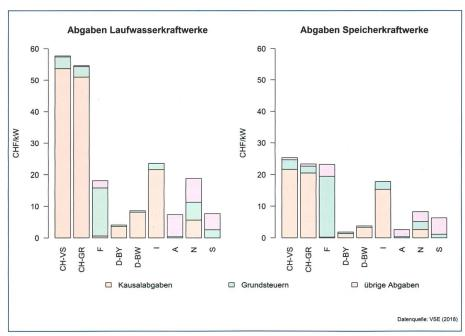
Bild 3. Übersicht über die gesetzlichen Abgaben (ohne Gewinnsteuern) für Laufwasser- und Speicherkraftwerke in Europa in CHF/kW. Abkürzungen: CH: Schweiz, F: Frankreich, D: Deutschland, I: Italien, A: Österreich, N: Norwegen, S: Schweden, VS: Wallis, GR: Graubünden, BY: Bayern, BW: Baden-Württemberg. Datenquelle: VSE (2018).
