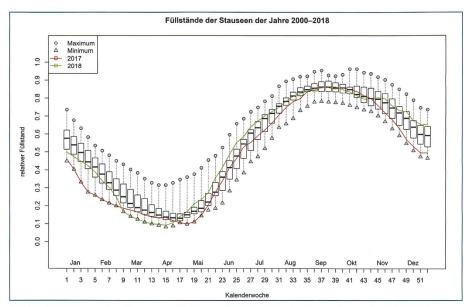
Bild 3. Füllstände der Stauseen 2017 und 2018 im Vergleich zur Periode 2000–2018 (SWV, Datenquelle, BFE).
