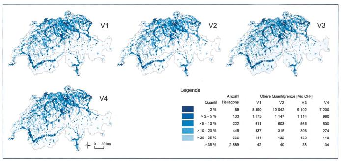
Bild 2. Räumliche Verteilung der hochwasserexponierten Gebäudewerte, aufsummiert auf regelmässige Hexagone von 10 km² Fläche. Für jede der vier Schätzmethoden werden sechs Quantile farblich differenziert dargestellt.
