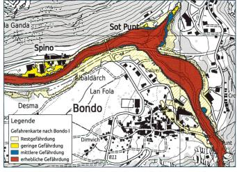
Bild 8. Gefahrenkarte Wasser 2016 nach Schutzmassnahmen Bondo I 2014/15.
