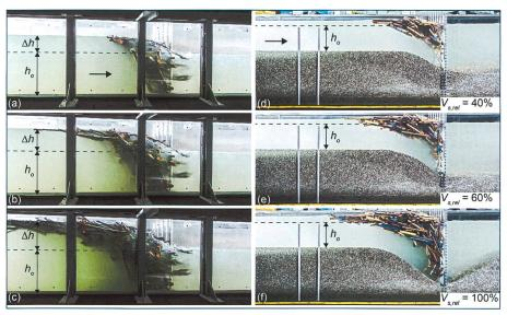
Bild 7. Natürliche Schwemmholzverklausung mit  $V_{s,rel} = 40-100\%$ ; (a)–(c) feste Sohle und  $\lambda = 6$  (Serie B) und (d)–(f) bewegliche Sohle und  $\lambda = 30$  (Serie C).
