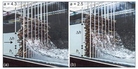
Bild 5. Aufstau  $\triangle$ h infolge Schwemmholzverklausung für (a) a=4.3 versus (b) a=2.5 ( $h_o=0.10$  m,  $F_o=0.8$ ,  $L_A=0.10$  m und  $d_L=7$  mm).
