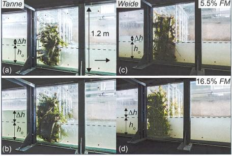
Bild 6. Aufstau  $\triangle h$  infolge Schwemmholzverklausung mit zunehmendem FM-Anteil ( $F_o$  = 0.3,  $h_o$  = 0.36 m, a = 4.2,  $L_A$  = 0.50 m, und  $d_L$  = 65 mm); (a-b) Tannenzweige und (c-d) Weidenäste.
