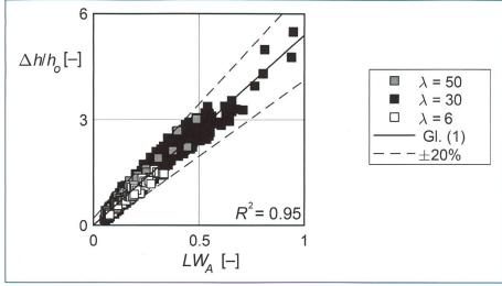
Bild 8. Relativer Aufstau  $\Delta h/h_o$  als Funktion von LW<sub>A</sub> für Serie A ( $\lambda$  = 50,  $\lambda$  = 30,  $\lambda$  = 6), Gl.(1), und ±20 % Abweichung.
