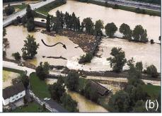
Bild 1. Schwemmholzverklausungen beim Hochwasserereignis 2005 (a) Eisenbahnbrücke Sarnen (Foto: Tiefbauamt Kanton OW) und (b) Wehr Perlen an der Reuss (Foto: Schweizer Luftwaffe).
