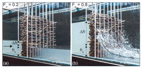
Bild 4. Aufstau  $\triangle h$  infolge Schwemmholzverklausung für (a)  $F_o = 0.20$  versus (b)  $F_o = 0.80$  ( $h_o = 0.10$  m, a = 3.3,  $L_A = 0.10$  m und  $d_L = 7$  mm).
