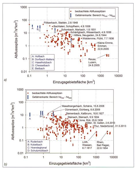
Bild 9 (a). Die spezifischen Abflüsse im Kt. LU im Vergleich mit stichprobenartigen  $HQ_{100}$  und  $HQ_{300}$  (Gefahrenkarte LU, Erstbeurteilung), (b) Die spezifischen Abflüsse im Kt. SG im Vergleich mit stichprobenartigen  $HQ_{100}$  und  $HQ_{300}$  (Gefahrenkarte SG).
