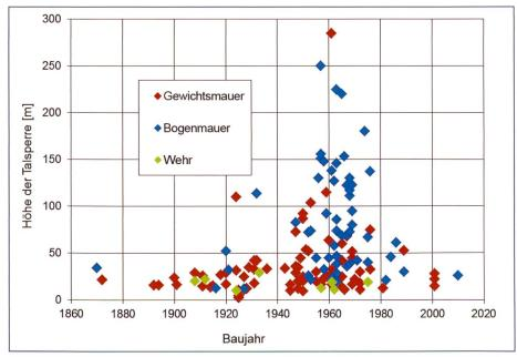
Bild 1. Art und Höhe der Talsperre in Abhängigkeit des Baujahrs.
