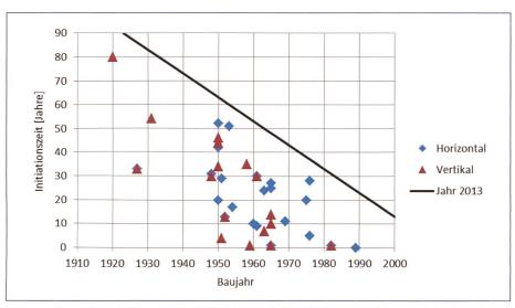
Bild 8. Dauer der Initiationszeit des Betonquellens bei verschiedenen Talsperren in Abhängigkeit des Baujahrs.
