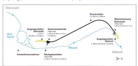
Bild 1. Situation der Anlage Gletsch-Oberwald.
