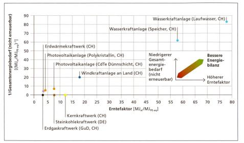
Die Gesamtenergiebilanz, ermittelt aus den Kennzahlen «Gesamtenergiebdarf (nicht erneuerbar)» und «Erntefaktor (EROI)», zeigt ein deutliches Bild. Die Wasserkraft schlägt alle übrigen Arten der Stromversorgung um Längen. Doch auch Photovoltaik und Windkraft schneiden gut ab.
