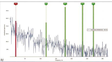
Bild 2. Aktuelle CM-Software erlaubt, intelligente Schwellwerte zu definieren. a) Fünf Schwellwerte werden automatisch erstellt; b) Die Alarmmeldung zeigt sogar, welcher Schwellwert den Alarm getriggert hat.
