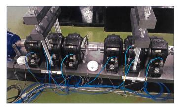
Bild 5. Prüfbank, die Vibrationsdaten von Industrielagern sammelt.
