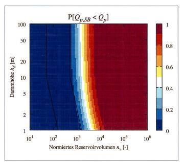
Bild 7. Vergleich zwischen dem probabilistisch kalibrierten Dammbruchmodell und der Methode der Standardbresche: Die Wahrscheinlichkeit, dass der mit der Methode der Standardbresche berechnete Spitzenabfluss  $(Q_{o,SB} = 2.58 h_d^{5/2})$ erreicht und überschritten wird im Vergleich zu Q<sub>n</sub>, berechnet mit BASEbreach.
