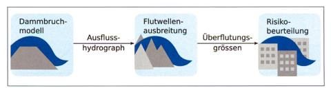
Bild 1. Dammbruchanalyse, aufgeteilt in die drei Teilmodelle: (1) Dammbruchmodell, (2) Berechnung der Flutwellenausbreitung und (3) Quantifizierung des Überflutungsrisikos resp. des sog. Gefährdungspotenzials (adaptiert nach Peter [2017]).
