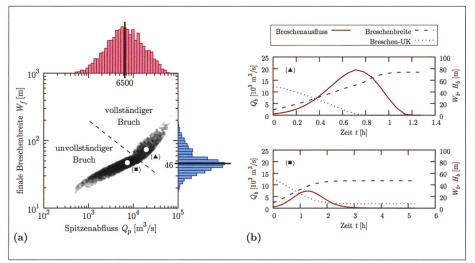
Bild 8. Resultat des probabilistischen Dammbruchmodells (adaptiert nach Peter [2017]): (a) 5000 mögliche Hydrographen im  $\mathbf{Q}_p$ – $W_f$  Raum, inklusive der Randverteilungen. Es sind sowohl vollständige Brüche als auch unvollständige Brüche zu erwarten; (b) zwei exemplarische Dammbrüche und deren Zeitreihen für ausgewählte Grössen, jeweils für einen vollständigen (oben) und unvollständigen (unten) Bruch.
