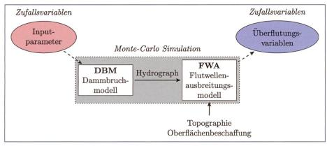
Bild 2. Vorgehensweise bei der Monte Carlo Simulation zur Berechnung der probabilistischen Überflutungsvariablen (adaptiert nach Peter [2017]).
