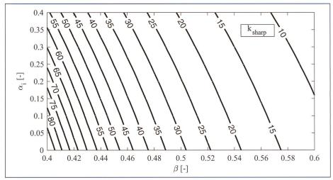
Figure 5. Variation du coefficient de perte de charge pour l'approche à angle vif pour le coefficient de contraction  $\beta$  variant de 0.4 à 0.6 et du coefficient d'épaisseur interne de l'orifice  $\alpha_i$  variant de 0 à 0.4.
