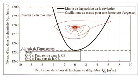
Figure 8. Evaluation graphique du risque d'apparition de la cavitation dans une cheminée d'équilibre soumis à une fermeture d'urgence entrant une oscillation de masse convergeante.
