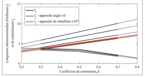
Figure 7. Evolution des longueurs adimensionnelles de rattachement  $I_r$  et d'influence  $I_j$  pour trois coefficients d'épaisseur ( $\alpha_i$ =0, 0.2 et 0.4) et deux angles vifs ( $\theta$ =0° et 45°).
