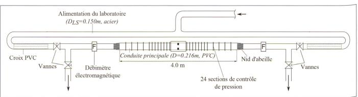
Figure 3. Vue schématique en plan du modèle expérimental (LCH-EPFL).
