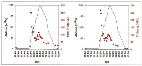
Bild 6. Verlauf der Gesamt-Phosphor-Konzentration (Total P in µg/L) und der Trübung (als Nephelometrischer Trübungswert, NTU) vor, während und nach dem künstlichen Hochwasser in der Restwasserstrecke der Saane rote Punkte). Der Abflussflussverlauf (schwarze Linie) basiert auf modellierten Daten für den Standort Kloster Hauterive.
