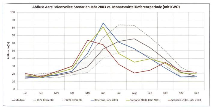
Bild 6. Monatsmittel-Abflüsse für das Jahr 2003 für die Referenzperiode und die Szenarien 2060 und 2085 im Vergleich mit dem Median und dem 10%- bzw. 90%-Perzentil der Monatsmittel aus der gesamten Referenzperiode (Konfiguraton mit KWO-Anlagen).
