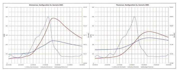
Bild 4. Dämpfende Wirkung des Brienzer- und Thunersees auf die Ausflüsse aus den beiden Seen für die Konfiguration 2a im Szenario 2005.
