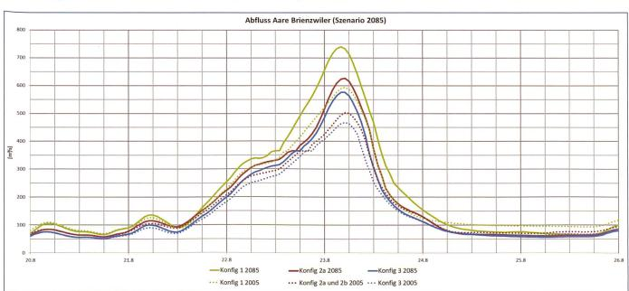
Bild 3. Hochwasserabflussganglinien für Szenario 2005 und Szenario 2085: Konfig 1: ohne KWO Speicherseen, Konfig 2: mit vorhandenen KWO-Speicherseen, Konfig 3: mit vorhandenen Stauseen plus Triftsee.
