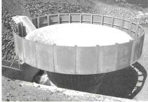
Bild 6. Tulpe mit Tauchwand im Geschiebesammler am Kelchbach in Naters, Kanton Wallis; Durchmesser der Tulpe ca. 14 m. Links: Modellversuch; rechts: Prototyp (Fotos: Lange und Bezzola, 2006).
