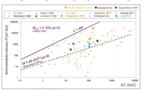
Bild 4. Beobachtete Schwemmholzvolumen (Festvolumen) bei vergangenen Hochwasserereignissen sowie Schätzformeln nach Rickenmann (1997) und Uchiogi (1996) (Auflockerungsfaktor a = 2).
