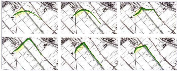
Bild 3. Hochwasserrückhaltebecken Wohlen: geprüfte Varianten der Dammlinienführung.
