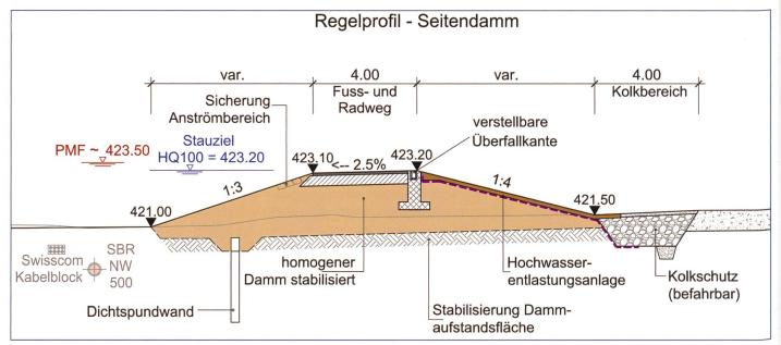
Bild 8. Hochwasserrückhaltebecken Wohlen, Querprofil.
